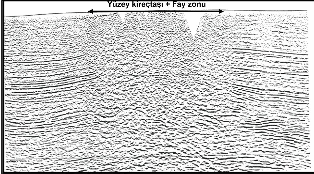
Şekil 7 : Sismik kesitte fay zonu tanımı (TPAO)
